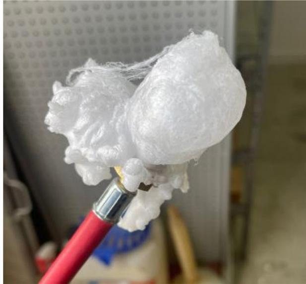
Aunque las razones no se han aclarado al 100%, este fenómeno puede producirse debido a la humedad y las altas temperaturas, por ejemplo, cuando las botellas de gas están expuestas a la luz solar directa o hay una válvula de presión con fugas.
