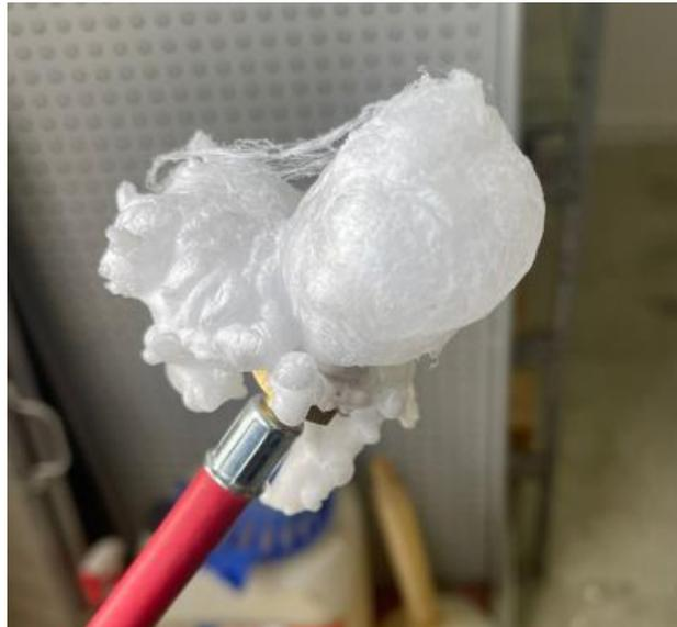
Bien que les raisons n'aient pas été élucidées à 100 %, ce phénomène peut se produire en raison de l'humidité et de températures élevées, par exemple lorsque les bouteilles de gaz sont exposées à la lumière directe du soleil ou qu'il y a une fuite au niveau de la soupape de pression.
